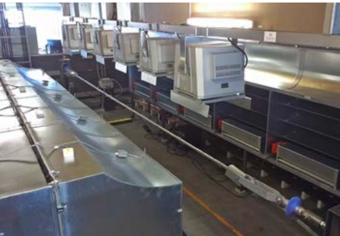
Abb. 1 Der Laboraufbau ermöglichte es den Wissenschaftlern, vielfältige Wetterbedingungen zu simulieren. Die Tageslichtlampen oben simulierten die Solarstrahlung, der Windkanal strömte die Leitung im Winkel von 90° an.
