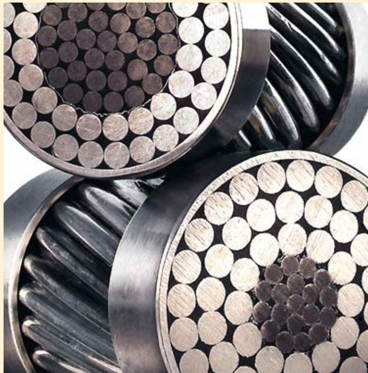
Abb. 2 Sowohl die Drähte im Kern als auch die Aluminium-Zirkonium-Drähte im Mantel tragen zur Zugfestigkeit und zur Leitfähigkeit des ACCR-Seils bei.
