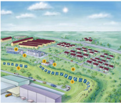
Die solarthermische Anlage Hirtenwiese II umfasst neben der rund 7.400 qm großen Kollektorfläche (1), eine Solarstation (2), einen Heißwasserspeicher (3), eine Solarzentrale (4) und zwei Pufferspeicher (5). © Stadtwerke Crailsheim
