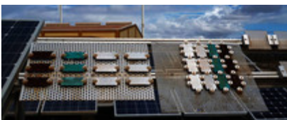
Die Abbildung zeigt exponierte Metallcoupons zur Bestimmung der Korrosivität der Atmosphäre am maritimen Teststand auf der spanischen Insel Gran Canaria. © Fraunhofer ISE
