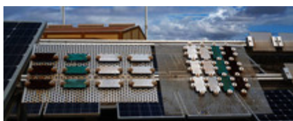
Die Abbildung zeigt exponierte Metallcoupons zur Bestimmung der Korrosivität der Atmosphäre am maritimen Teststand auf der spanischen Insel Gran Canaria. © Fraunhofer ISE
