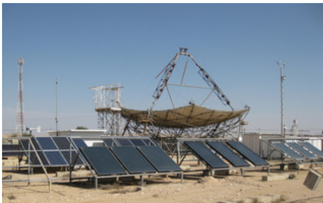
Wissenschaftler des Fraunhofer ISE untersuchen in der israelischen Wüste Negev die Alterung von Solarkollektoren und deren Komponenten unter extremen klimatischen Bedingungen. © Fraunhofer ISE
