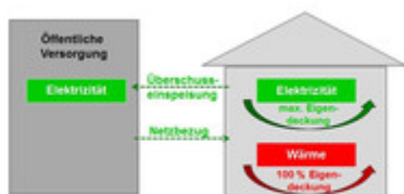
Elektrische Netzneutralität bedeutet Maximierung der Eigendeckung und -nutzung und somit die Reduzierung von Überschusseinspeisung und Netzbezug. © Hochschule München
