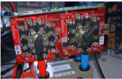
Die Abbildung zeigt die erste Konzeptversion eines Batterie Hauptschalters von Infineon. © Infineon Technologies AG
