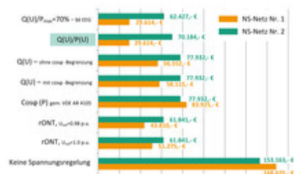
Investitionsbarwerte für einen PV-bedingten Netzausbau über zehn Jahre bei Nutzung von Regelungsverfahren für PV-Wechselrichter und regelbare Ortsnetzstationen: Im Vergleich sind die Kosten für den reinen Netzausbau ohne Spannungsregelung dargestellt. © Fraunhofer IWES
