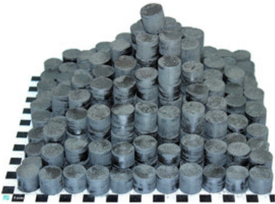
Die Abbildung zeigt den gepressten Metallhydrid-Verbundwerkstoff in pelletierter Form. © Fraunhofer IFAM
