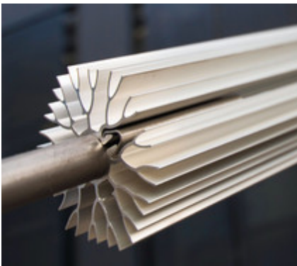
Wärmeübertrager-Rohr. Die Wärme wird über die Rippenstruktur auf das Salz übertragen. © DLR
