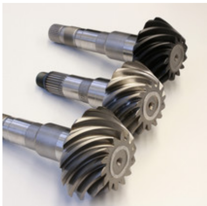
Antriebskegelräder im Vergleich: Zu sehen ist ein Antriebskegelrad im Serienzustand, ein besonders geglättetes und eines mit einer diamantähnlichen Beschichtung versehen. © BMW
