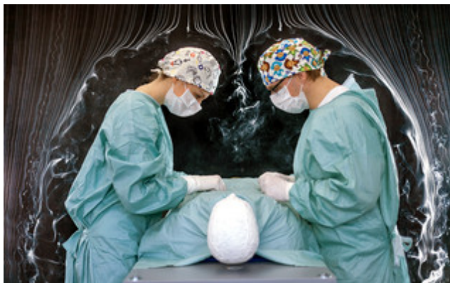
Die Abbildung zeigt die Umströmung von Operateuren am OP-Tisch unter einer TAV
