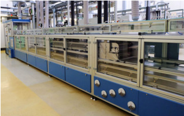
Probelauf der sequentiellen Foliengießbank im Forschungszentrum Jülich: Der Folienguss startet links unten, anhand der Umlenkrollen ist der dreistufige Aufbau der Anlage erkennbar. © Gerhard Hirn, BINE Informationsdienst
