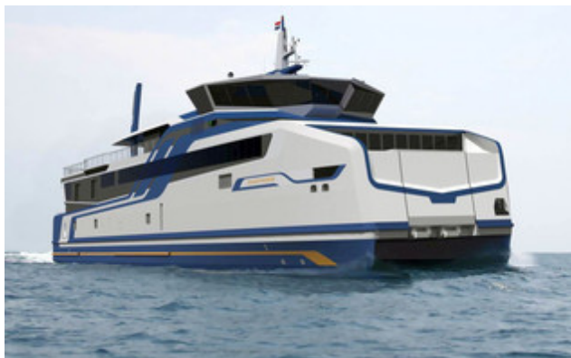
Ab 2018 wird die niederländische Reederei Doeksen zwei Aluminium-Katamarane, ausgestattet mit den neuen MTU-Gasmotoren, als Fähren im Wattenmeer einsetzen. © MTU Friedrichshafen / Strategic Marine
