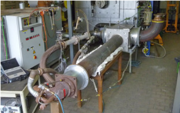
Die Rekuperatoren wurden am Versuchstand der Brennerversuchsanlage getestet. Der Demonstrator ist als silbrig glänzender Würfel zu erkennen.
