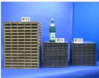
Die Wärmeübertrager-Elemente schrumpfen im Laufe der thermischen Behandlung vom Holzfaser-Modell bis zum Siliziumcarbid-Würfel stark: Ausgangszustand (WT3.5), carbonisierter (WT3.4) und silizierter Zustand (WT3.3). Nach der Behandlung haben die Elemente noch eine Kantenlänge von 30 Zentimetern.
