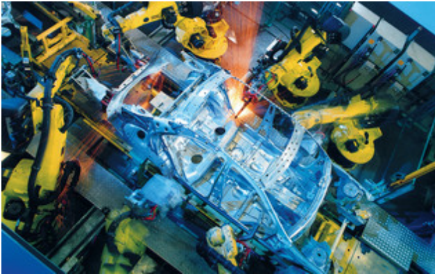
Ein Automobilwerk verbraucht pro Jahr so viel Energie wie eine mittelgroße Stadt – besonders Roboter sind dabei unersättlich. Mit optimierten Bewegungen können sie bis zu 50 Prozent Strom sparen. © Siemens
