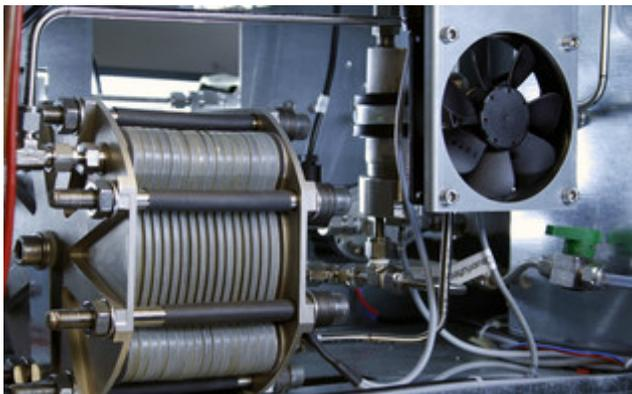
Membran-Elektrolysezellstapel in einem am Fraunhofer ISE entwickelten Prototyp eines Druckelektrolyseurs
