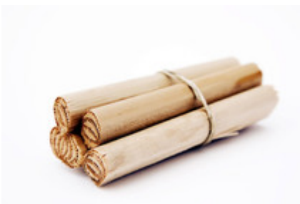
Die Typhablätter weisen ein faserverstärktes Stützgewebe auf, das mit weichem, offenzelligem Schwammgewebe ausgefüllt ist. © typha technik Naturbaustoffe
