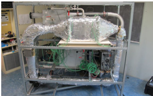
Die Adsorptionskälte-Versuchsanlage im Labor: Zu erkennen ist der komplette Zyklus mit Adsorber (im Vordergrund) und Verdampfer/Kondensator-Einheit im Hintergrund. © ITW, Universität Stuttgart
