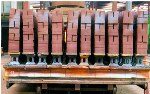
Ein Ofenwagen mit Ziegeln wartet auf den Brennvorgang. © SIZ Energie und Umwelttechnik
