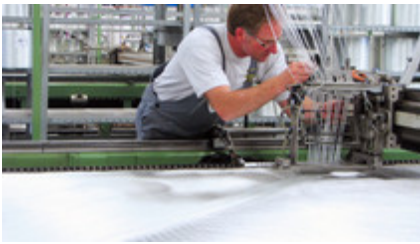
Ein Mitarbeiter des Gelegetherstellers Saertex rüstet eine Maschine zur Produktion ein. Zu erkennen sind die parallel verlaufenden Fäden, die in mehreren Lagen übereinander angeordnet werden. © Saertex
