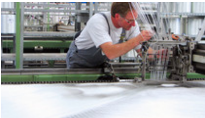
Ein Mitarbeiter des Gelegeherstellers Saertex rüstet eine Maschine zur Produktion ein. Zu erkennen sind die parallel verlaufenden Fäden, die in mehreren Lagen übereinander angeordnet werden. © Saertex
