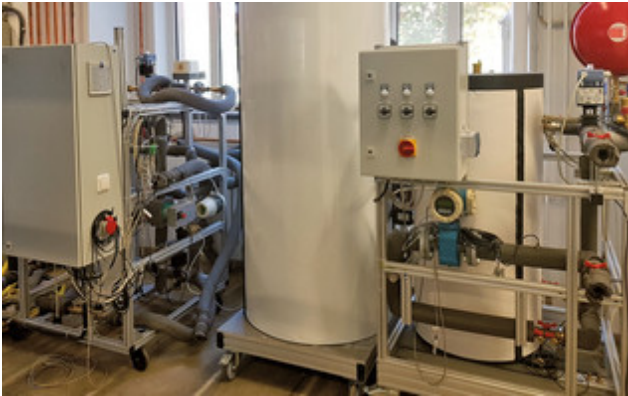
Mit der Methode Hardware-in-the-Loop (HiL) wurde ein Prüfverfahren entwickelt, mit dem die energetische Effizienz von Wärmepumpen und Blockheizkraftwerken schnell und realitätsnah bewertet werden. © TU Dresden, Institut für Energietechnik
