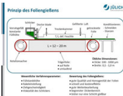
Hier ist das Prinzip des Foliengießens am Beispiel einer einstufigen Anlage dargestellt. © Forschungszentrum Jülich, IEK-1
