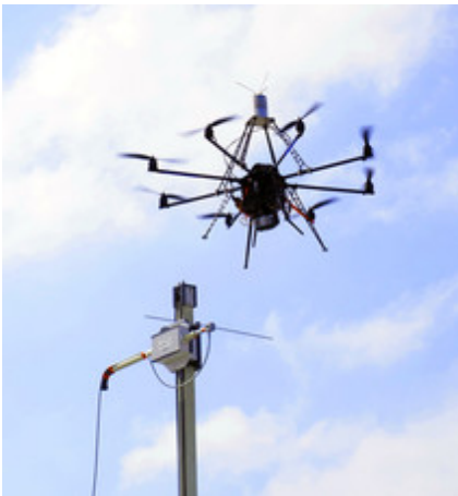
Mithilfe eines sogenannten Oktokopters (im Bild) kann das miniaturisierte Messsystem für Radaranlagen durch Windparks fliegen und an beliebigen Punkten im Raum Messungen durchführen. © PTB
