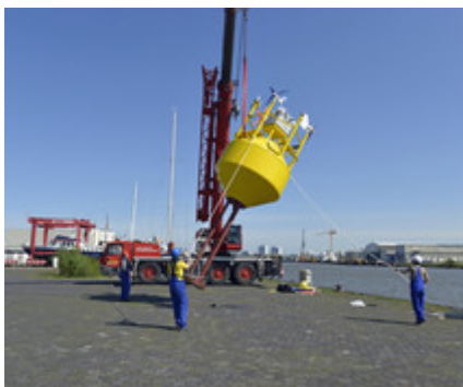
Mitarbeiter des Fraunhofer IWES richten die Boje an der Kaikante auf und setzen das Messgerät anschließend ins Hafenbecken. Von Bremerhaven aus startete die Boje ihre Reise in Richtung des Offshore-Testfeld alpha ventus 45 km vor Borkum. © Fraunhofer IWES
