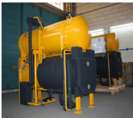
Die Absorptionskälteanlage „Biene“ hat eine Leistung von 50 kW. © TU Berlin
