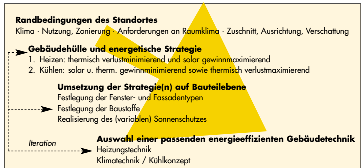
Entwurfsstrategie zur Minimierung des Energieaufwandes für Kühlung und zur Auswahl des Kühlkonzeptes
