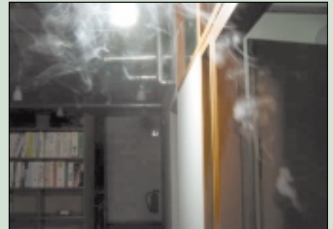
Strömungsvisualisierung: Die Luft strömt durch das Fenster in das Büro und aus dem Büro in das Treppenhaus.
