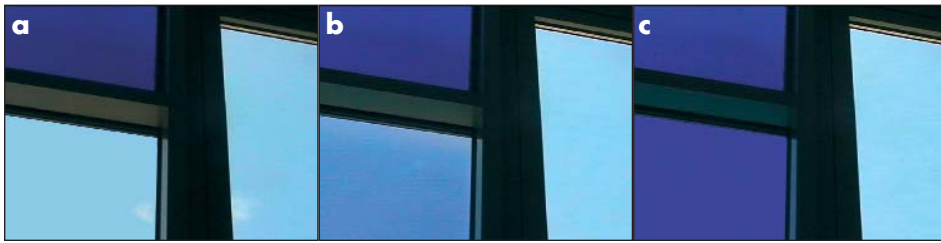
14 Gaschrome Verglasung in verschiedenen Schaltzuständen. Jeweils rechtes Element: unbeschichtete Standardverglasung. Element links oben: gaschrome Verglasung im gefärbten Zustand. Element links unten: gaschrome Verglasung; (a) gebleicht, (b) teilweise eingefärbt, (c) stark eingefärbt. Quelle: Fraunhofer ISE / Interpane E&B mbH
