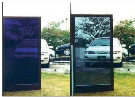
25 Kleines Muster eines durch Wasserstoffgas schaltbaren Spiegels (HYSWIM). Quelle: Prof. R. Griessen, Vrije Univ. Amsterdam
