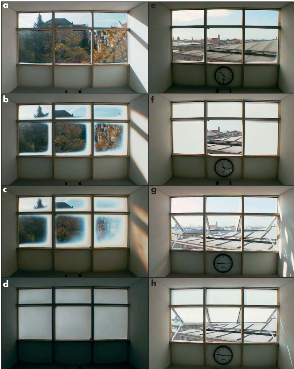
20 a-d: Schaltvorgang einer mit thermotropen Hydrogel-Verbundscheiben ausgestatteten Bürofassade als 1:2,5-Skalenmodell. Um den Vorgang zu verdeutlichen wurde die gesamte Fassade thermotrop belegt, was in der Anwendung kaum sinnvoll ist. e-h: Andere Anordnungen: nur teillächige Belegung klar (e) und geschaltet (f) und als auskragendes Element klar (g) und geschaltet (h) Quelle: H. Hartwig, TU München / Thermotrope Gläser: Affinity Co. Ltd., Japan
