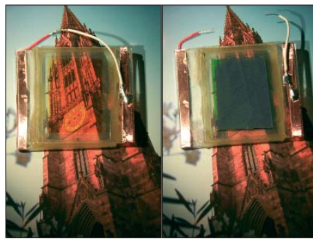
17 Photoelektrochromer Prototyp im Labormaßstab. Links der klare, rechts der abgedunkelte Zustand. Quelle: Fraunhofer ISE
