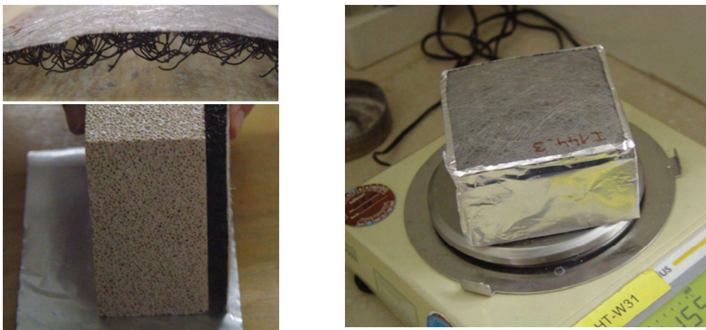
Bild 8 Versuchsaufbau mit diffusionsoffener Folie. Die Folie mit Wirrgelege ist links oben dargestellt, darunter die Probe mit aufgelegter Folie, daneben der Probenaufbau mit seitlicher Abdichtung.
