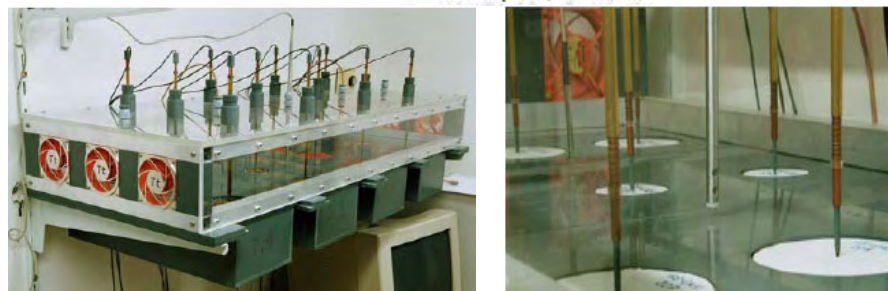
Bild 10 Messapparatur, entwickelt um unter definierten Randbedingungen den Trocknungsverlauf zu ermitteln. Oben: Schematische Darstellung der Messeinrichtung Unten links: Photographische Ansicht der Messeinrichtung Unten rechts: Photographische Ansicht der installierten Messsensoren.
