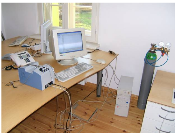
Bild 10: Gasanalysator ( \text{SF}_6 ), Auswerteeinheit und Gasflasche der Indikatorgas-Messeinrichtung
