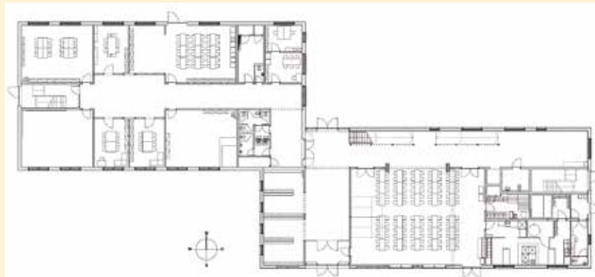
Abb. 1 Erdgeschoss-Grundriss der St. Franziskus Grundschule (Technik, Sanitärräume, Schulküche mit Aula und Hort)
