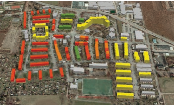
Abb. 1 Wärmebedarfssimulation des Bestandsquartiers Grünbühl mit einem 3D-Stadtmodell
