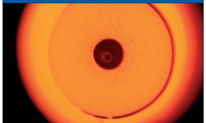
Abb. 6: Nahezu unsichtbare Reaktionszone: flammenloser Brenner im Einsatz
