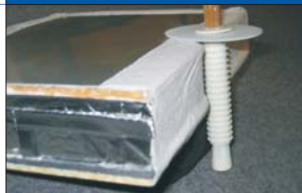
Abb 3: Glasfaseranker als Verbindungselement der Fertigteil-Konstruktion
