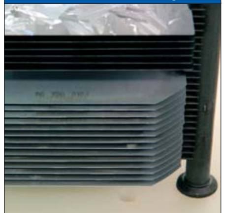
Abb 2: Wafer mit Laser-Codierung
