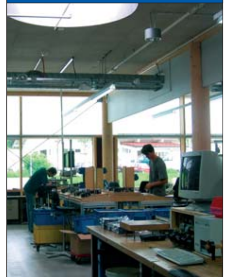
Abb 6: Lichtkuppeln und TWD-Oberlichter bringen Tageslicht tief in die Werkstätten
