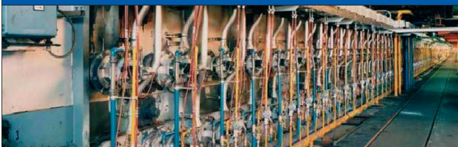
Abb 5: Hunderte von keramischen FLOX-Brennern befeuern einen Glühofen
