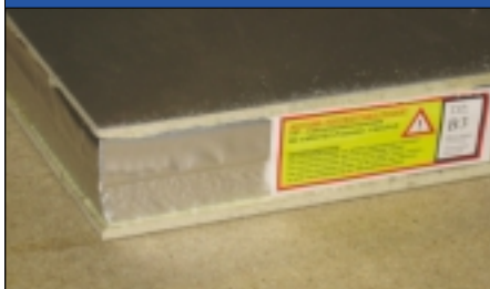
Abb 7: In eine PUR-Materialkombination eingepacktes Vakuum-Panel
