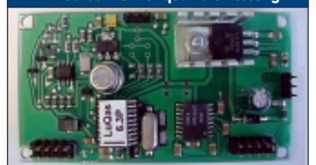
Abb 4 Auswertelektronik mit integriertem Sensor zur Luftqualitätsmessung
