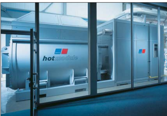
Abb. 9 Hochtemperaturbrennstoffzelle auf Basis SO-FC. Das Modul erbringt typischerweise eine Leistung von 245 kW Strom und 180 kW Wärme. Bis Sommer 2006 wurden 35 Module installiert [MTU].
