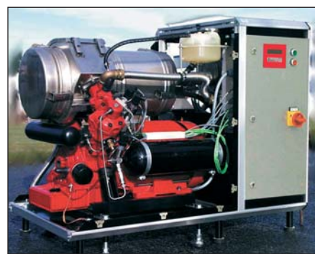
Abb. 13 Stirling BHKW. Die elektrische Leistung liegt bei 2 – 7,5 kW und die thermische Leistung bei 8 – 22 kW. Damit wird ein Gesamtwirkungsgrad von 92 – 96% [Hu] erreicht [Quelle: Fa. Solo].
