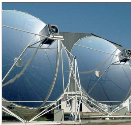
Abb. 14 Beim EuroDish-Stirling System konzentrieren die Spiegel das einfallende Sonnenlicht auf den im Brennpunkt befindlichen Stirling.
