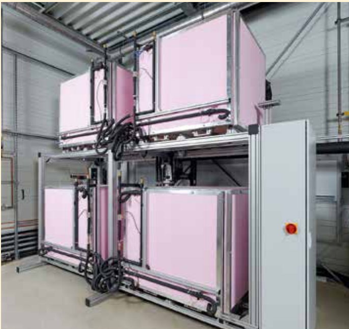
Abb. 4 Gesamtansicht der HiL-Kabinen zur Abbildung des hydraulischen Heizungsnetzes einer Wohnung mit vier Räumen.
