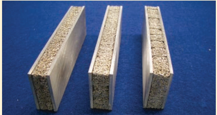
Abb. 2 Für Wärmeübergangsmessungen wurden neben Metallschäumen auch ausgewählte Faserstrukturen als Sandwichprobe gefertigt.
