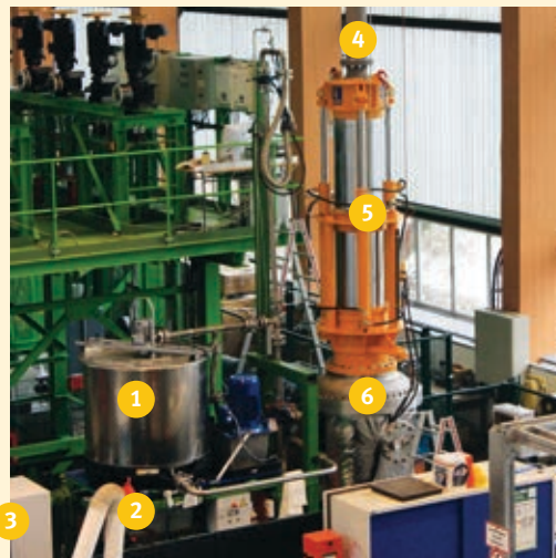
Abb. 2 Auf diesem Versuchsstand in Dresden wurde der Prototyp unter bohrlochähnlichen Bedingungen getestet.
