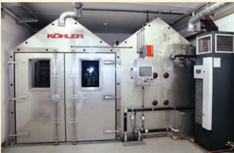
Abb. 5 Außenansicht der 4,2 m breiten und 2,8 m tiefen Klimakammer, in der Tests mit Süß- und Salzwasser durchgeführt werden.
