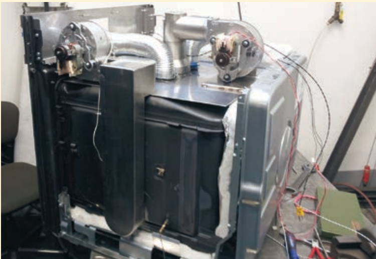
Abb. 4 Der Demonstrator hat bereits die standardisierten Maße eines handelsüblichen Einbaubackofens.
