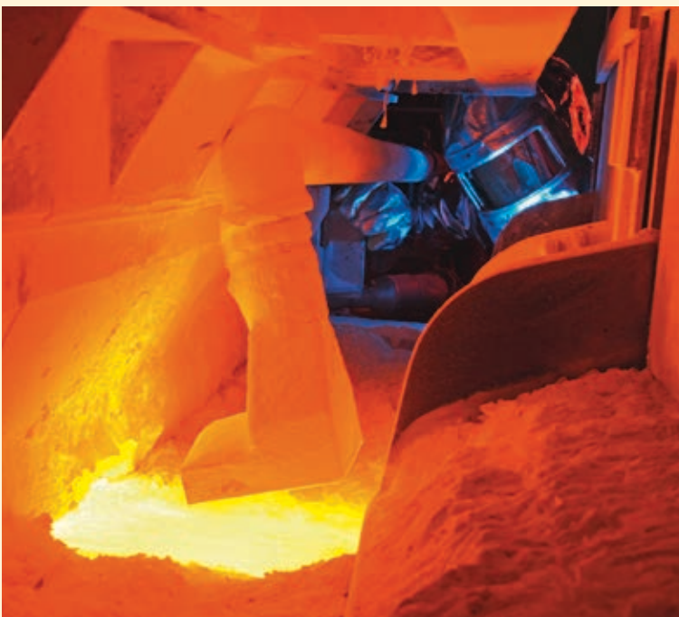
Abb. 3 Blick in die Schmelzwanne der Microfloatanlage in Jena.
