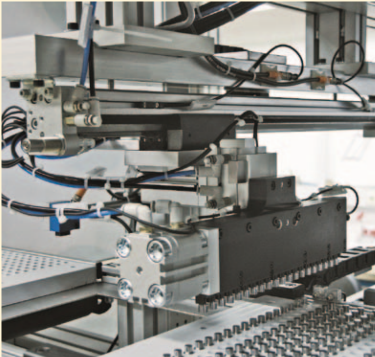
Abb. 4 Elektrische Zuführanlage für automobiler Einspritztechnik Quelle: Festo AG
